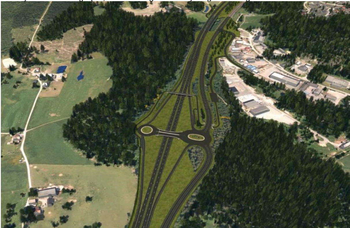
Figur 7. Fullt kryss ved Ås, sett mot nord.
